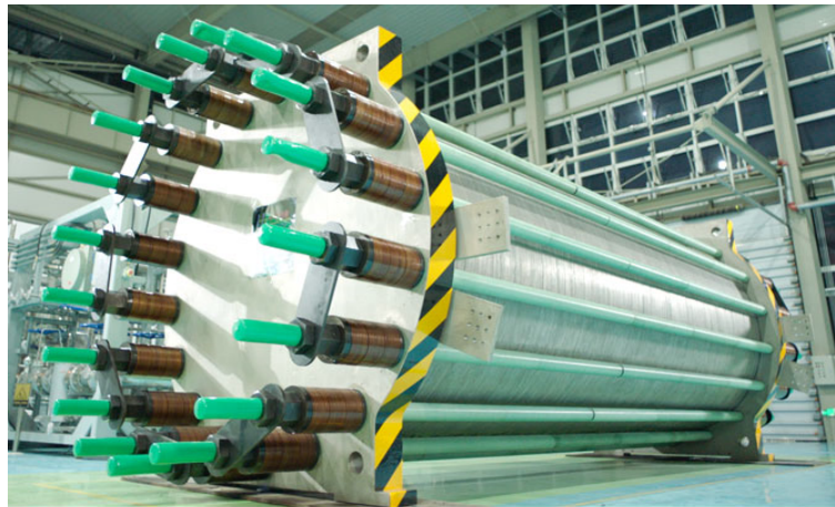
Abbildung 3-21: Bild eines 10 MW-AEL-Stacks der Fa. SynoHy Energy (China) als Beispiel für die Skalierbarkeit der AEL (SinoHy Energy, 2024)
